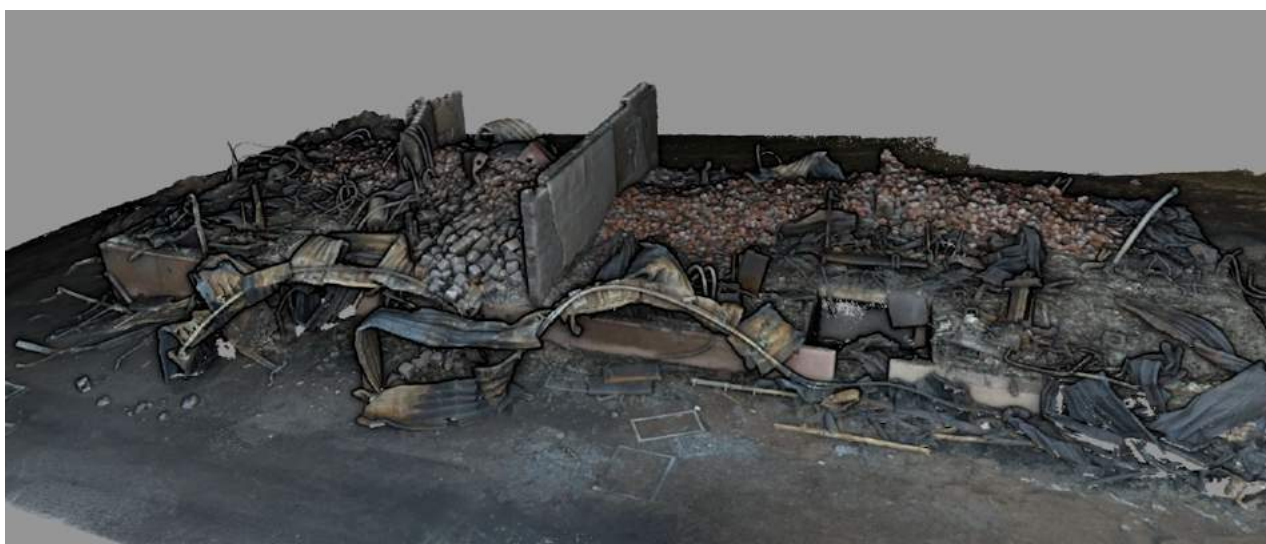
Figur 9. Fotogrammetrisk 3D-modell baserad på UAS-foton.
