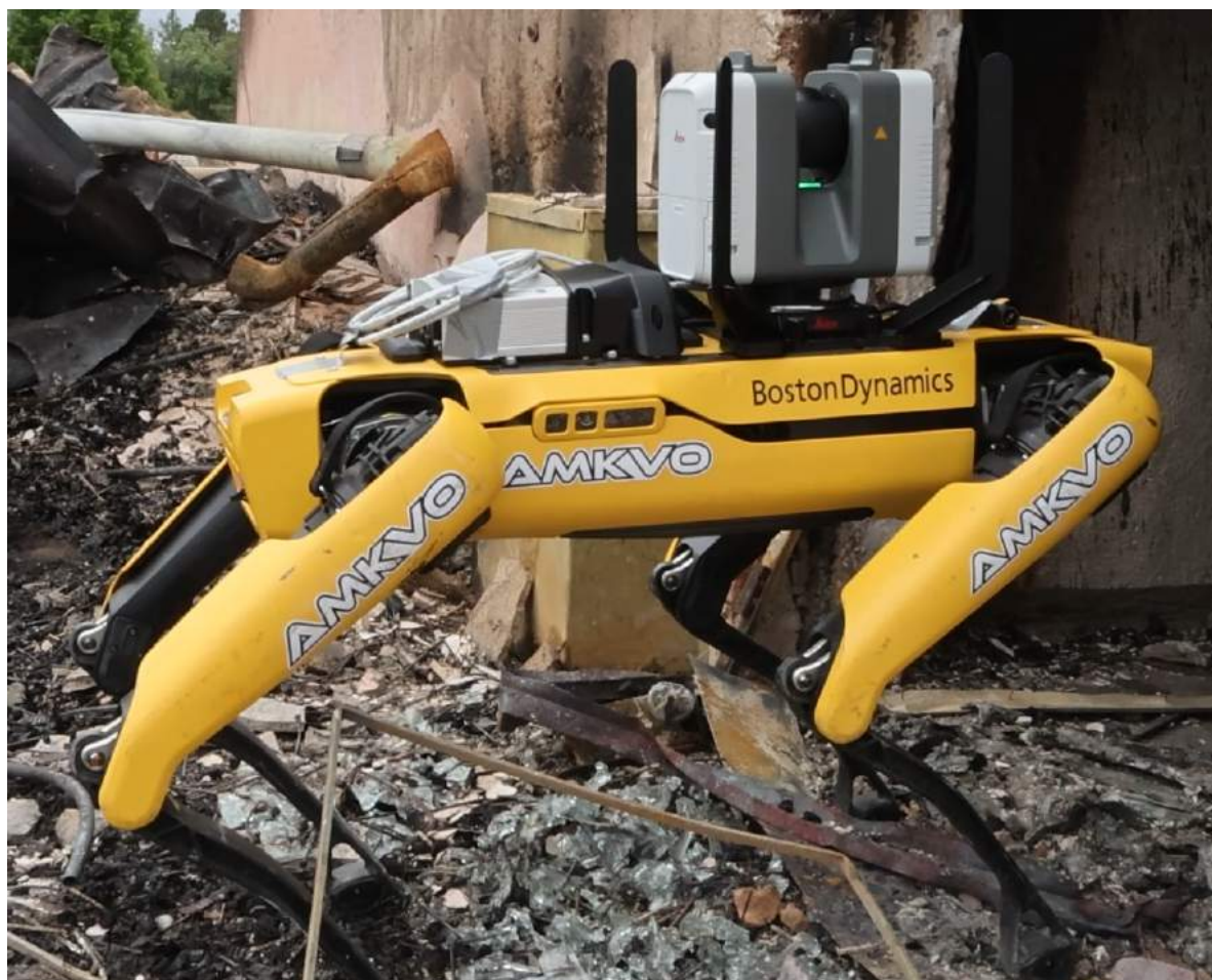
Figur 5. Boston Dynamics Spot försedd med laserskanner Leica RTC360.
