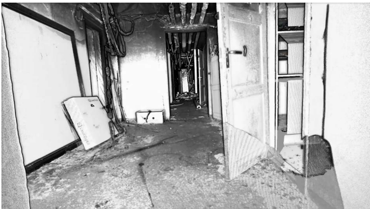
Figur 8. Bild från 3D-modellen av källaren visad med laserintensitet.
