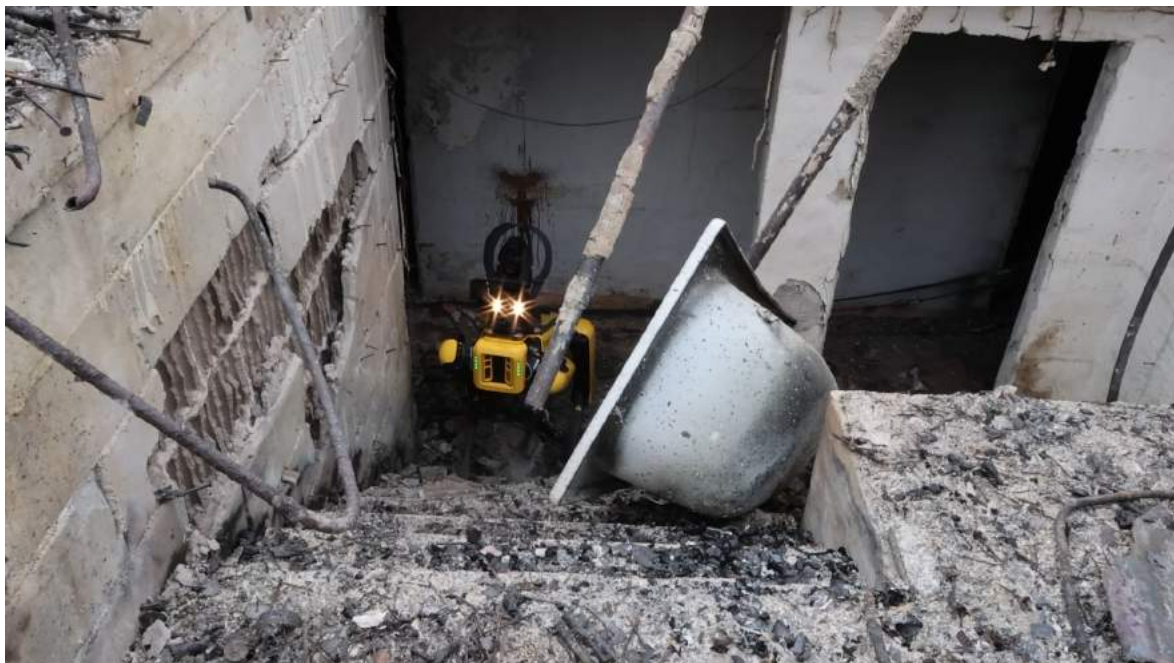
Figur 3. Boston Dynamics spot försedd med en GoPro kamera och belysning.
