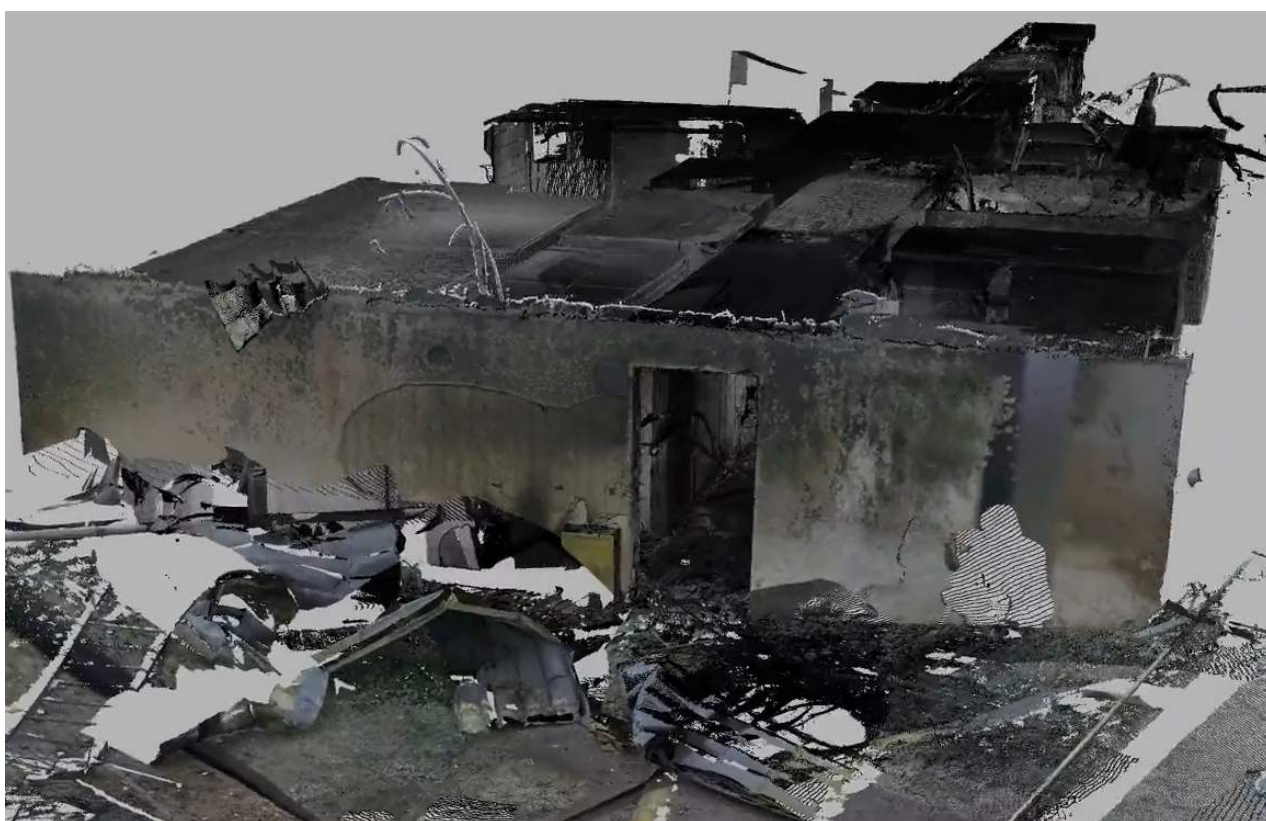
Figur 7. 3D-modellen av källaren genererad med 3D-data från den markbundna 3D-laserskannern.
